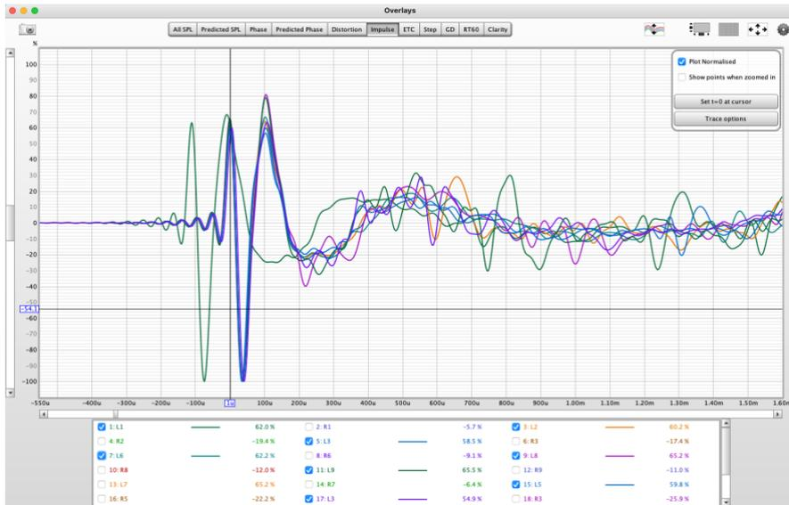
On peut alors ajuster l'alignement manuellement de chaque impulsion. La méthode la plus rapide et simple, consiste à afficher les impulsions les unes après les autres sur l'onglet « overlays » (en n'en sélectionnant qu'une seule), et en positionnant le curseur au sommet de la première oscillation, puis en cliquant sur « set t=0 at cursor » dans le menu contextuel qu'on active en cliquant sur la roue dentée en haut à gauche de la fenêtre.
