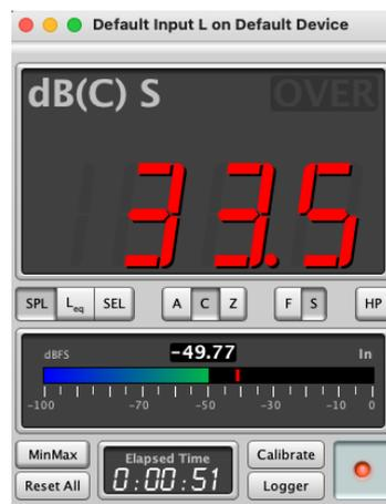
Ensuite il ne reste plus qu'à lancer le bruit rose L+R sur le CD, et ajuster le son sur l'ampli (ou préampli) de façon à ce que l'affichage monte entre 75dB et 85dB. Pour toutes les mesures ultérieures, il suffira de remettre le niveau de l'ampli au même niveau et de procéder directement aux mesures (plus besoin de recalibrer le niveau donc !).
